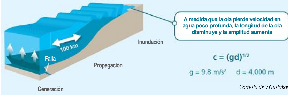
Figura 2: Descripción de un tsunami
