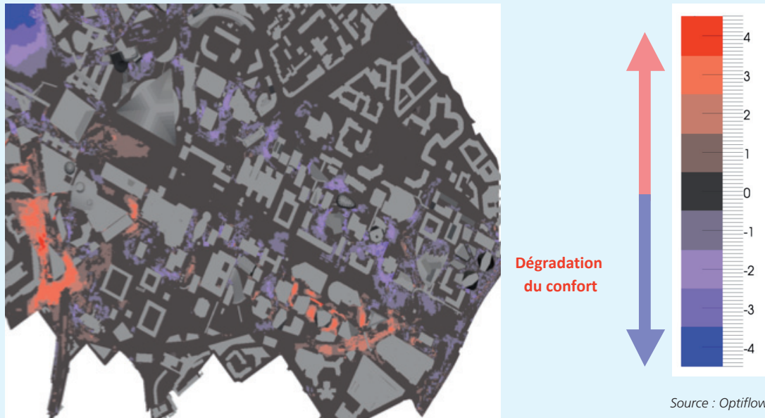
Figure 7 : Evolution du confort au vent de la dalle du quartier de la Défense Comparaison 2020/2015
